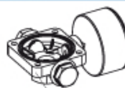
příruba čtyřcestná s tlakoměrem 4 way flange with pressure gauge
